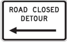
道路封闭。箭头指向绕行方向。
